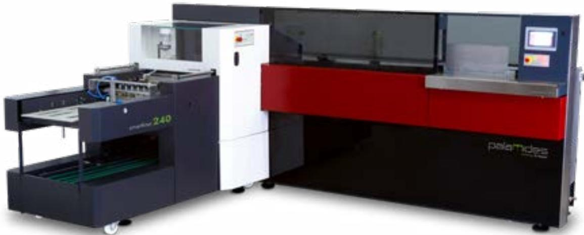
Mit der smartfl at-Technologie zur Herstellung von flach aufschlagenden Büchern, bietet der smartliner von palamides völlig neue Möglichkeiten. Das bedeutet, dass Bücher umweltfreundlich und energieeffizient gebunden werden können und dabei ein perfekt flachliegendes Aufschlagverhalten (layflat) erreicht wird. Es lassen sich nahezu alle Papierqualitäten und Grammaturen verarbeiten.
